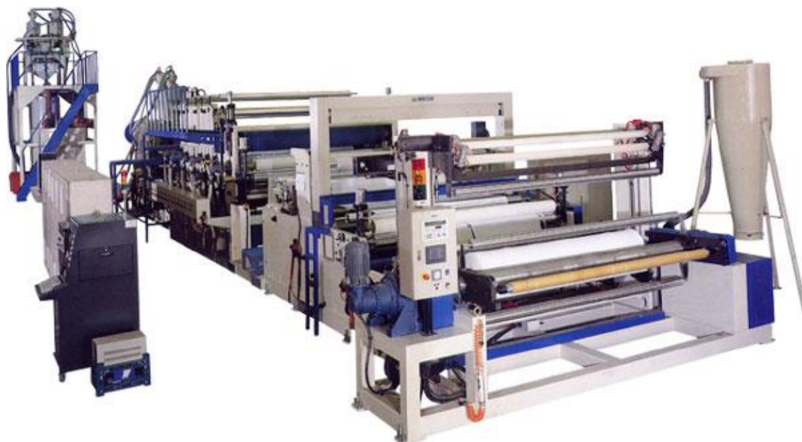
Sl. 81 — Postrojenje za proizvodnju folija livenjem (Amut) 1) ekstruder, 2) valjci za hlađenje, 3) uređaji za namotavanje, 4) izmenjivač toplote za temperiranje valjaka, 5) elektro ormarić za upravljanje
