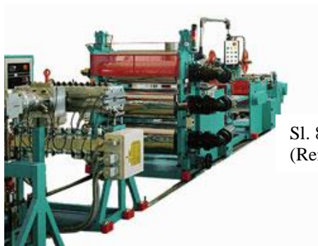
Sl. 81 — Postrojenje za proizvodnju folija livenjem (Amut) 1) ekstruder, 2) valjci za hlađenje, 3) uređaji za namotavanje, 4) izmenjivač toplote za temperiranje valjaka, 5) elektro ormarić za upravljanje
