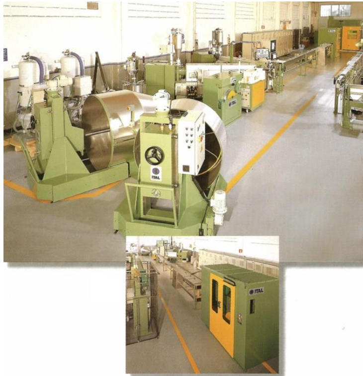
Sl.124 — Detalj roizvodnje kablova. Na njemu se vidi ekstruder sa krstastom glavom, usmerivač žice, kada za hlađenje i elektro ormarić za upravljanje.(Thyssen)
