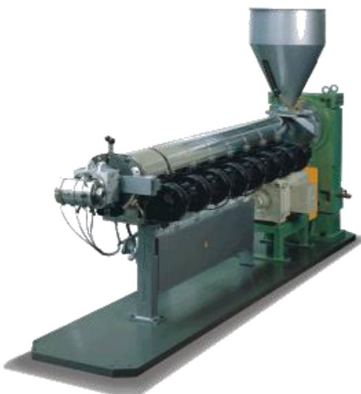
Sl. 5 — Jednopužni ekstruder sa krstastom glavom za oblaganje žice vazdušno hlađen (Troester)
