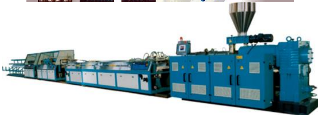
Sl. 104 — Proizvodna linija za profile (Troester) (elektro ormarić, ekstruder, alat, kalibrator, hlađenje, sečenje i odlaganje)
