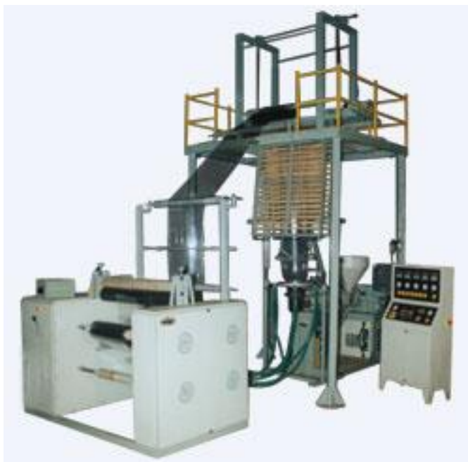
Sl. 77 — Postrojenje za proizvodnju folija iz polietilena velike gustine, postupkom duvanja (Amut)
