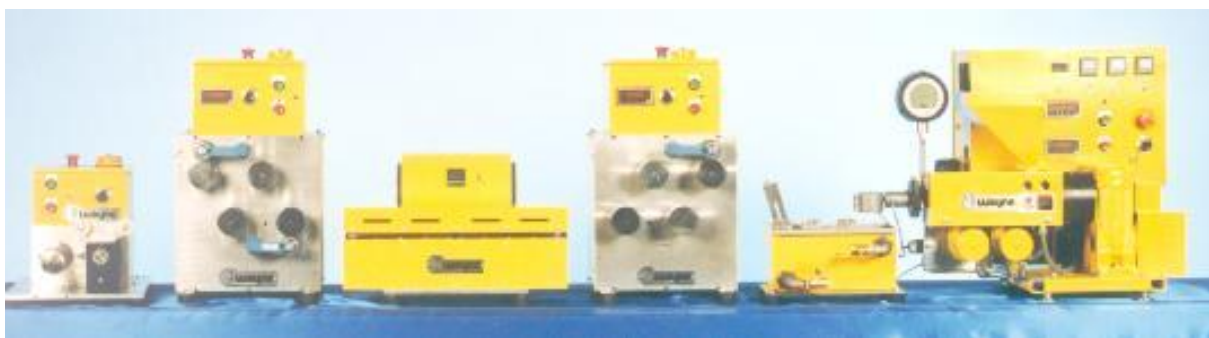
Sl. 130 — Deo postrojenja za izradu niti, u prvom planu su uređaji za istezanje (Barmag)
