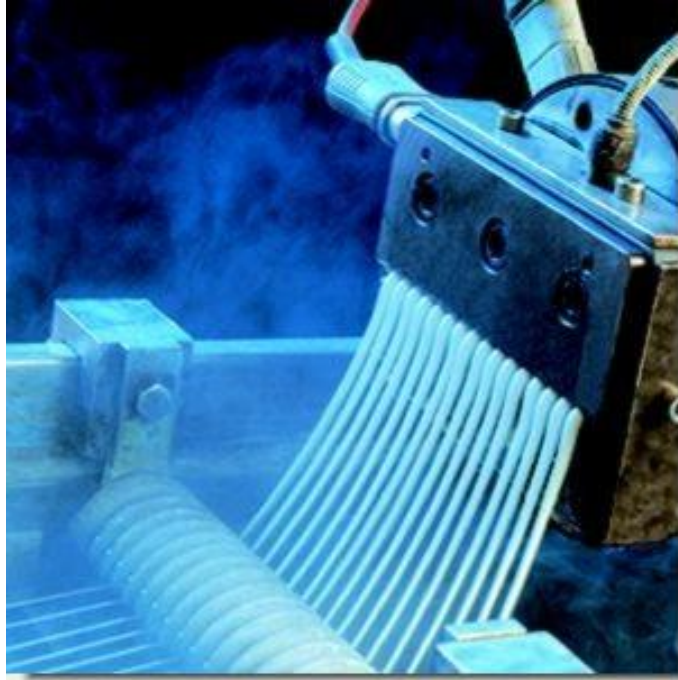
Sl. 158 — Detalj alata za izradu granulata iz niti. Slika prikazuje ulazak niti u kadu za hlađenje (Troester)
