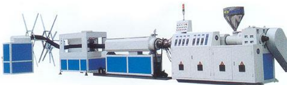
Sl.89 — Skica postrojenja za proizvodnju cevi (Thyssen): 1) dvopužni ekstruder, 2) alat, 3) kalibrator, 4) vakuum pumpa, 5) komora za hlađenje cevi vodom, 6) vakuum pumpa za potrebe hlađenja cevi, 7) uređaj za vučenje cevi
