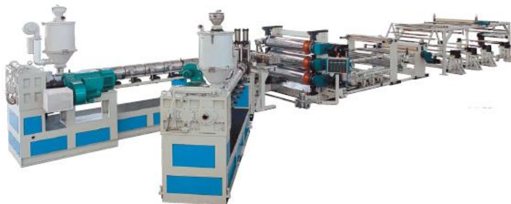
Sl. 24 — Ekstruder u tandem sprezi sa alatima za izradu cevi i ploča(Kaufman)
